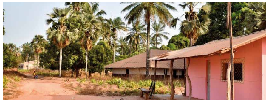
Foto 45 - Casa “neo-tradicional” de adobe, revestida com um reboco de cimento e uma camada de pintura, telhado de zinco mantido por vigas de madeira, aberturas sem janelas dobráveis e porta de metal
